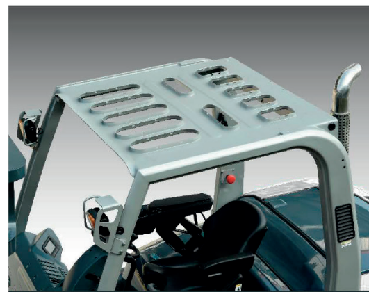
Lo stampaggio del tettuccio di protezione migliora la resistenza del tetto e migliora la sicurezza operativa
