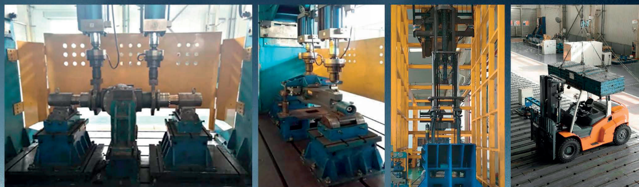
Prova di fatica dell'asse sterzante
